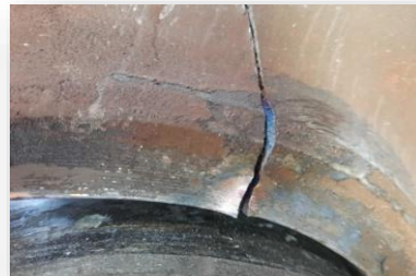
16.10.2023 излом диска колеса на перегоне Аур - Ин ДВОСТ
