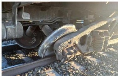
06.08.2023 излом оси на перегоне Мынкуль – Валиханово 3-СИБ
