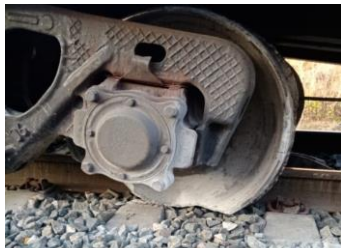
01.10.2023 излом диска колеса на перегоне Чернушка – Куеда ГОРЬК
